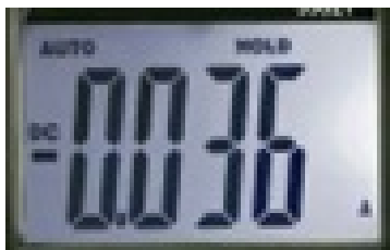
Multimètre utilisé en ampèremètre (précision : 0,5\%L + 0,5 \text{ dgt} )
