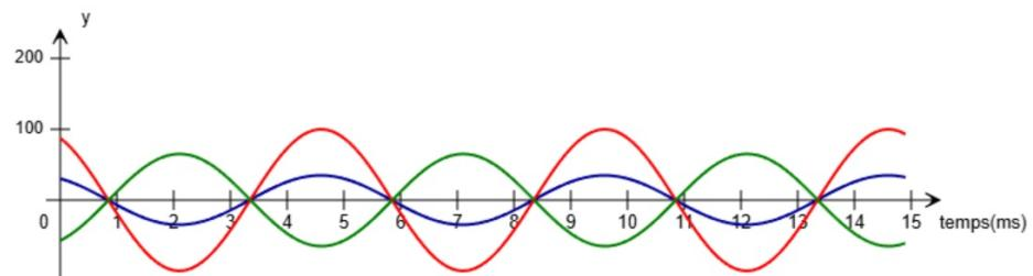
$s_1$  est maximal quand  $s_2$  est minimal (et inversement), les signaux sont dits **en opposition de phase**. L'amplitude résultante est inférieure à celle de  $s_1$  et à celle de  $s_2$ , on parle d'interférences **destructives**.
