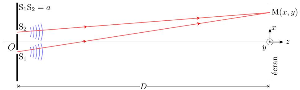
Dans le dispositif des trous d'Young placés sur la droite ( $Ox$ ), la différence de chemin optique au point  $M$ , de coordonnées  $(x, y, D)$  vaut :
