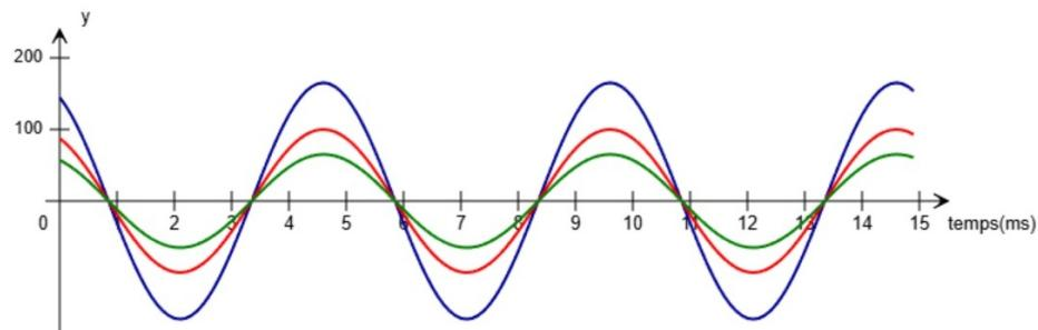
$s_1$  et  $s_2$  ont leurs maxima simultanément, les signaux sont dits **en phase**. L'amplitude résultante est supérieure à celle de  $s_1$  et celle de  $s_2$ , on parle d'interférences **constructives**.
