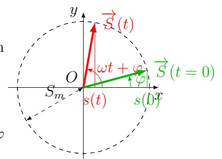
Le vecteur  $\vec{S}$  tourne dans le plan  $(Oxy)$ , autour de l'axe  $(Oz)$ , à la vitesse angulaire  $\omega$ , il fait un tour en  $T = \frac{2\pi}{\omega}$ . **Utilisation pour sommer des signaux sinusoïdaux :**
