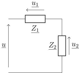
La formule du pont diviseur de tension est encore valable avec les impédances complexes, avec la même hypothèse d'un courant identique dans les deux dipôles :
