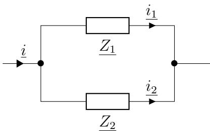
La formule du pont diviseur de courant est encore valable avec les impédances complexes, avec la même hypothèse d'une tension identique aux bornes des deux dipôles :
