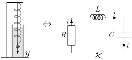
En mécanique ce sont les frottements qui sont responsables de l'amortissement des oscillations, en électricité il est dû au caractère résistif du circuit. On adopte dans ce chapitre le modèle du frottement fluide en introduisant une force de frottement qui s'oppose toujours au déplacement et dont l'intensité est proportionnelle à la vitesse :  $\vec{f} = -\alpha \vec{v}$  avec  $\alpha > 0$  constant.
