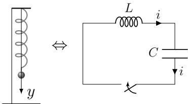
Après avoir montré que le circuit  $LC$  donne lieu à des oscillations électriques de la même façon qu'un système masse-ressort sans frottements peut osciller indéfiniment en mécanique, nous allons nous intéresser au cas réel où les oscillations subissent un amortissement.
