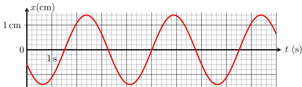
Q5. Déterminer les caractéristiques de l'oscillation : amplitude, pulsation propre, phase à l'origine.
