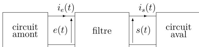
Un filtre est un quadripôle qui agit sur un signal d'entrée  $e(t)$  pour générer un signal de sortie  $s(t)$ .  $u_s(t)$  dépend de  $u_e(t)$ , de la nature du filtre et du circuit aval. Pour s'affranchir de l'influence du circuit aval, on s'intéresse le plus souvent à la situation en sortie ouverte ( $i_s = 0$ ).
