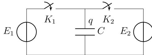
On suppose que le dispositif fonctionne depuis suffisamment longtemps pour que l'évolution temporelle de la charge de  $C$  soit périodique :  $q(nT) = q(nT + T)$ .
