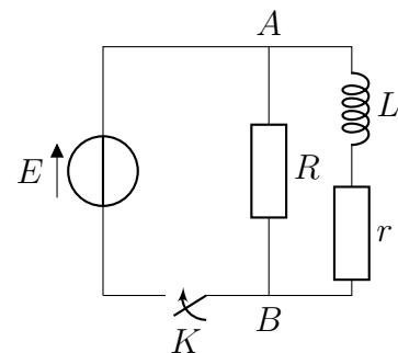
Q1. À l'instant  $t = 0$ , on ferme l'interrupteur  $K$ . Déterminer les courants dans le résistor  $R$  (noté  $i_R$ ) et dans la bobine ( $i_L$ ).
