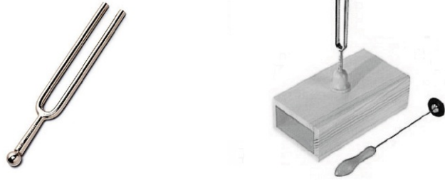
FIGURE 1 – à gauche : diapason de musicien ; à droite : diapason (avec son marteau) muni d'une caisse de résonance pour améliorer l'émission sonore, utilisé dans l'enseignement
