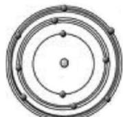
**Modèle planétaire amélioré, Bohr (1913) :** Les électrons gravitent autour du noyau sur des orbites définies, appelées couches électroniques. L'émission ou l'absorption de lumière par la matière s'explique par le changement d'orbite d'un électron.
