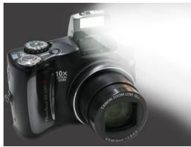
← Le flash d'un appareil photo : il s'allume lors de la décharge très rapide d'un condensateur, et il faut attendre un peu entre deux photos avec flash.
